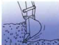
硬岩から土砂までバウフルに浚渫し、ならし、岩石の精込みなど幅広い作業に対応。
