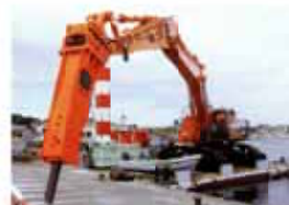
油圧プレーカを取り付けて、突進や護岸の破碎が行えます。
